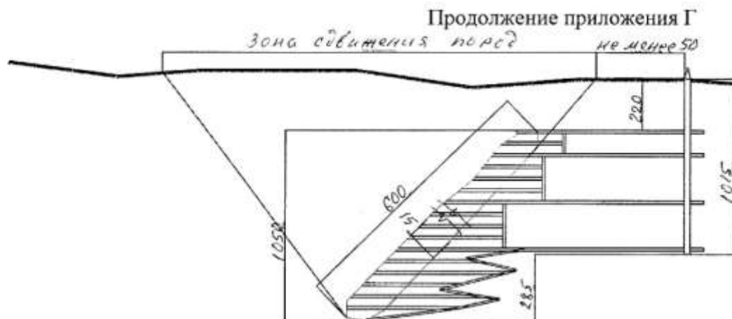
Рисунок Г.2 - Вскрытие основным вертикальным стволом в лежащем боку, с переходом на транспортный уклон, вспомогательными стволами по флангам
